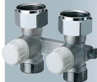
Art. 1424 Valvola MONO-BITUBO diritta. By-pass regolabile. Attacchi: FAR 24 x 19 Interasse derivazioni: 50 mm
