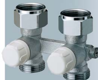
Art. 1423 Valvola MONO-BITUBO diritta. By-pass regolabile. Attacchi: 3/4" EUROKONUS Interasse derivazioni: 50 mm
