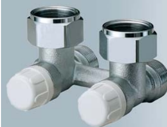
Art. 1422 Valvola MONO-BITUBO a squadra. By-pass regolabile. Attacchi: FAR 24 x 19 Interasse derivazioni: 50 mm
