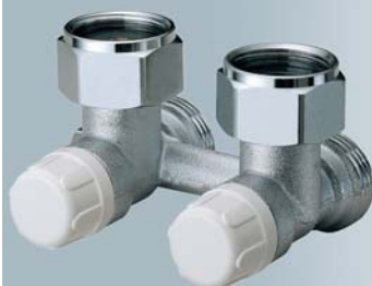
Art. 1421 Valvola MONO-BITUBO a squadra. By-pass regolabile. Attacchi: 3/4" EUROKONUS Interasse derivazioni: 50 mm
