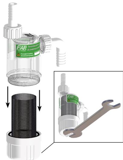
**1** Svitare la parte inferiore del neutralizzatore. Per agevolare l'apertura, nella parte inferiore è presente un rilievo per chiave da 13mm.
